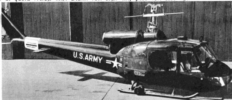
**BELL 204, YH-40** — Esaposto a turbina (Lycoming T-53 da 325 kg.sp.), da impieghi vari, per l'Esercito. Diam. rot. 13,4 m.; peso tot. 2549 kg.; vel. max. 245 kmh..
