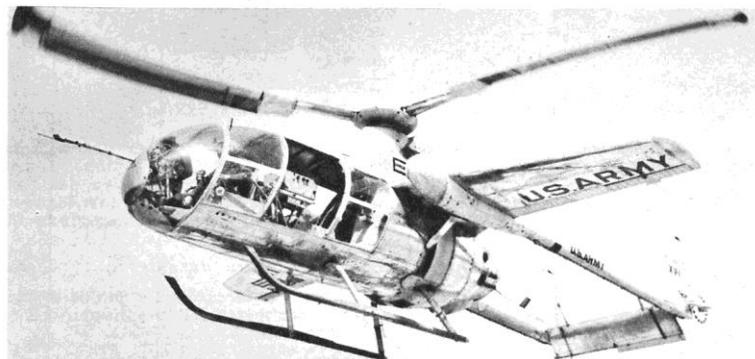
**Mc DONNELL, Mod. 82, XV-1 (XH-35)**. Quadriposto, potenziato da un Continental R-975 da 550 cv., che per il decollo aziona un compressore per i tre bruciatori del rotore, passando poi a muovere l'elica propulsiva e lasciando il rotore in autorotazione. Il primo passaggio dal volo verticale a quello orizzontale avvenne il 29-4-1955. Apertura alare 7,93 m.; lungh. 9,15 m.; vel. max. 322 kmh..
