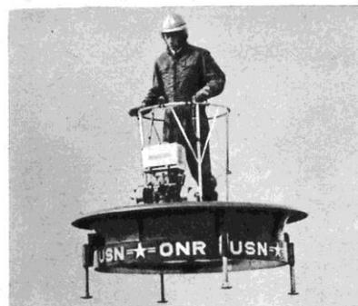
**HILLER «Flying Platform»** — Caratterizzato dal rotore intubato (doppio, coassiale), e dalla posizione eretta del pilota. Costruito nel 1955 per l'U. S. N., Office of Naval Research, si presta quale elicottero individuale ma soprattutto prelude a macchine più importanti. Motore Nelson H-19 ad 80 cv. Le caratteristiche non sono note.
