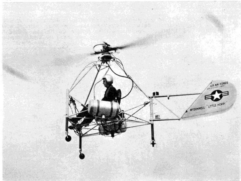
**Mc DONNELL J-1, H-20 «Little Henry»** — Elicottero sperimentale costruito per provare la propulsione «ram-jet»; primo volo 5-5-1947. Dai serbatoi presso il pilota il combustibile (propano) raggiunge le estremità delle pale ove viene bruciato in due autoreattori. Ha provveduto interessanti dati sul sistema di propulsione e di controllo di macchine del genere. Diametro rotore 5,49 m.; peso a vuoto 127 kg.; vel. max. 80 kmh..
