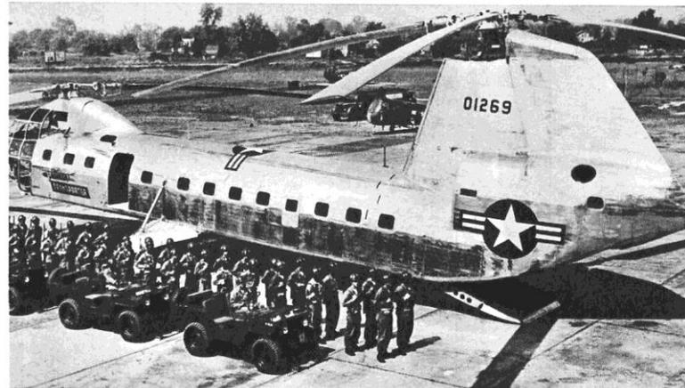
**VERTOL PV-15, H-16 «Transporter»** — Uno dei più grandi elicotteri del mondo (40 posti più 3), costruito in due esemplari: YH-16 con due P&W R-2180 da 1650 cv. e YH-16A «Turbo Transporter» con due turbine Allison T-38 da 3000 cv.. Il primo ebbe poi i motori sostituiti da due turbine Allison T-56 da 3750 cv., e la sigla YH-16V. Diam. rot. 25 m.; peso tot. 13608 kg.; vel. mar. (YH-16A) 200 kmh.; tang. 5490 m.; raggio d'az. 322 km..
