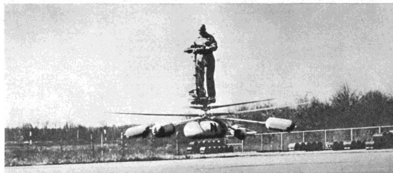
**DE LACKNER DH-4, «Aero Cycle»** — Elicottero individuale di facilissimo pilotaggio studiato per la Fanteria. Caratteristico per il posto di pilotaggio sistemato sopra il doppio rotore coassiale. Motore Mercury da 44 cv.. Diam. rot. 4,5 m.; peso a vuoto 74,8 kg.; vel. max. 128 kmh..
