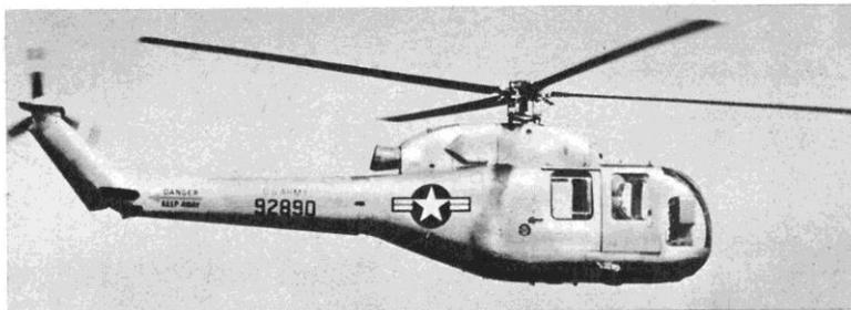
**SIKORSKY S-59, XH-39A** — Sviluppato nel 1954 dall'ultima versione dello S-52 (YH-18B). Bi-quadriposto a turbina (Continental T-51 limitata a 320 kg.sp.), con carrello retrattile. Conquistò i primati di velocità (249,6 kmh.), e di quota (7472,5 m.). Diam. rot. 10,67 m.; peso tot. 1616 kg..
