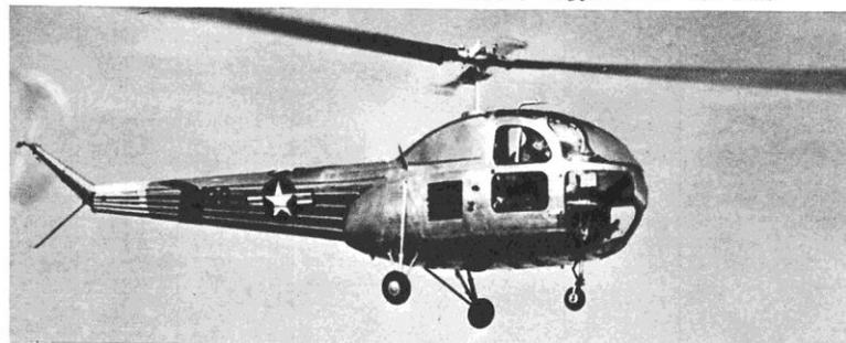
**BELL Mod. 54, H-15** — Quadriposto, poi convertito in biposto, sviluppato dal mod. 47 e caratterizzato da un'elevata tangenza (6100 m.); costruiti solo i tre prototipi XH-15, primo volo marzo 1950. Motore Continental XO-470-5 da 285 cv.. Diam. rot. 11,38 m.; p. tot. 2777 kg.; vel. mar. 160 kmh.; raggio d'azione 320 km..
