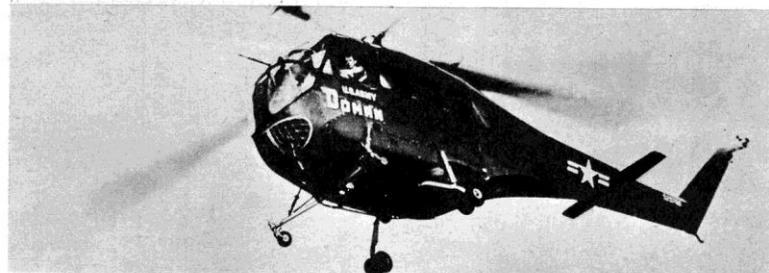
**DOMAN LZ-5 YH-31** — Eptaposto con rotore inclinabile, motore Lycoming da 400 cv.. Sperimentato quale lanciarazzi. Costruito anche in Canada dalla Fleet-Doman. Diam. rot. 14,64 m.; peso tot. 2006 kg.; vel. max. 166 chilometri orari.
