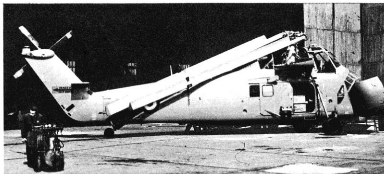
Dimensioni e caratteristiche Sikorsky HSS-1: diametro rotore 17,07 m., lunghezza fusoliera 14,25, altezza 4,86; peso totale 5900, a vuoto 3461; velocità max. 198 km-h., di crociera 157; hovering in effetto suolo 1770 m.; autonomia 578 km.
