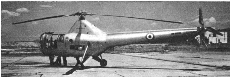
Dimensioni e caratteristiche Westland-Sikorsky S. 51: diametro rotore 14,93 m., lunghezza fusoliera 12,49, altezza 3,85; peso totale 2900 kg., a vuoto 1990; velocità max. 165 km-h., di crociera 130.
