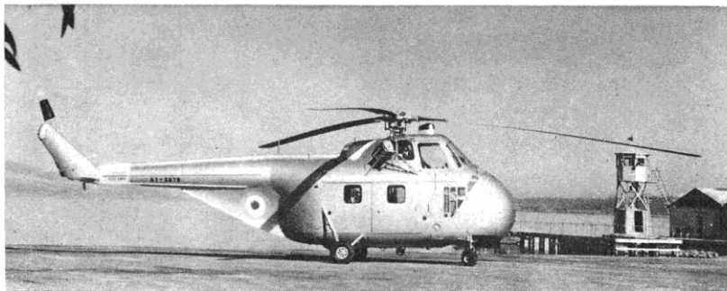
Dimensioni e caratteristiche Sikorsky S. 55: diametro rotore 16,16 m., lunghezza fusoliera 12,88, altezza 4,07; peso totale max. 3583 kg., a vuoto 2381; velocità max. 180 km-h., di crociera 148; hovering in effetto suolo 1770 m.; autonomia 578 km.
