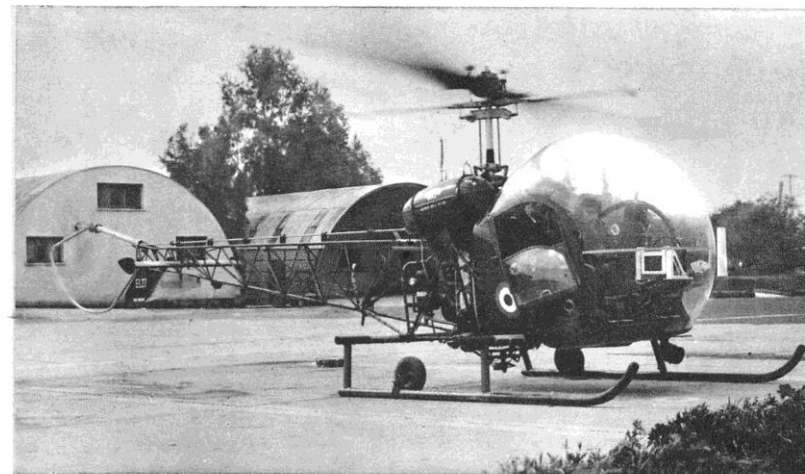
Dimensioni e caratteristiche Agusta-Bell G-3: diametro rotore 11,32 m., lunghezza 13,17 m., altezza 2,83 m.; peso totale 1293 kg., a vuoto 777; velocità max. 169 km-h., di crociera 146; tangenza 6600; hovering in effetto suolo 5500 m.; autonomia 325 km.
