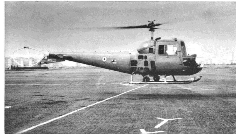
Dimensioni e caratteristiche Agusta-Bell 47 I-2 «Super Ranger»: diametro rotore 11,32 m., lunghezza 13,21, altezza 2,83; peso totale 1293 kg., a vuoto 612; velocità max. 169 km-h., di crociera 150; tangenza pratica 3690; hovering in effetto suolo 2805 m.; autonomia 320 km.
