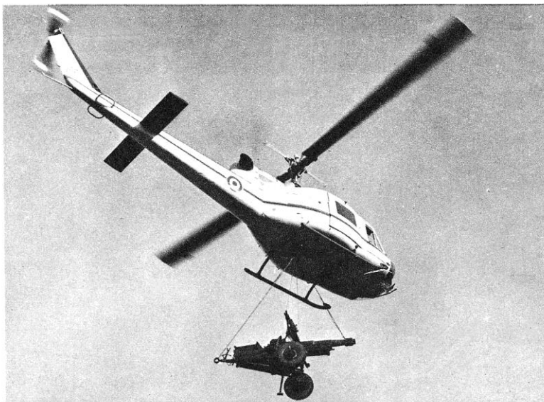
Dimensioni e caratteristiche Agusta-Bell 204 B: diametro rotore 13,41 m., lunghezza fusoliera 11,71, altezza 3,79; peso totale max. 3850 kg., a vuoto 1860; velocità max. 215 km-h., di crociera 193; hovering in effetto suolo 3260 m.; autonomia 378 km.
